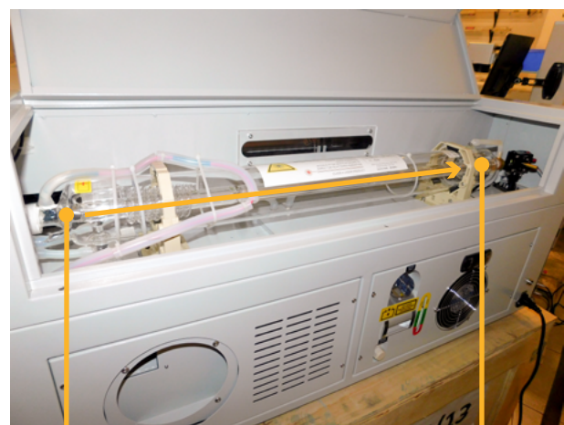
Entrada de agua
