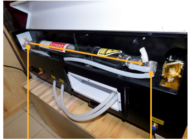
Entrada de agua
